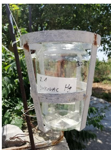
Grafički prikaz B-3: Izgled i položaj mjerne postaje Vukovac u odnosu na izvore onečišćenja
